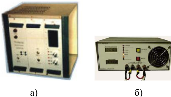
Рис. 2.26. а) Устройство измерения емкости АБ (согласно ГОСТ Р 53165-2008) (производство компании «АВАК» (Украина)); б) устройство для разряда и измерения параметров свинцово-кислотных АБ (производство ООО «Мегарон» (Россия))
