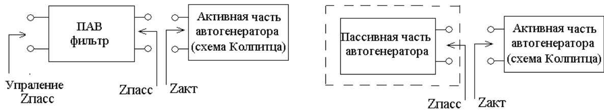
Рисунок 3 – Преобразование четырехполюсного ПАВ компонента в эквивалентный управляемый двухполюсник
