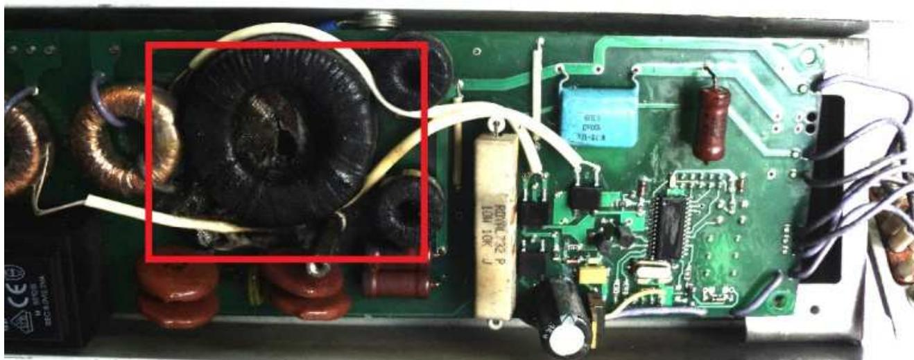
Рис. П.1.2 – Сквозные прожоги на плате аппаратуры «Барьер-АБЧК», содержащей микроконтроллер
