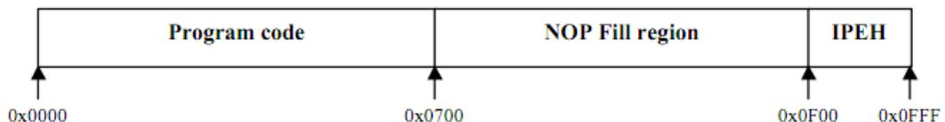
Рис. 1.12. Пример заполнения неиспользуемой области программ пустыми операциями
