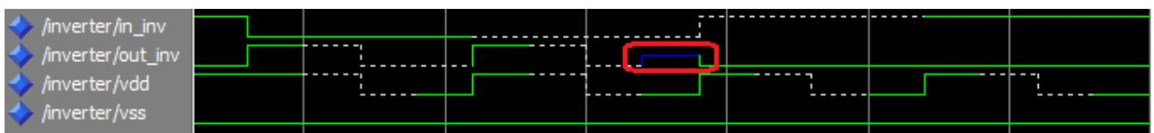
Рис. 4.4. Диаграмма работы инвертора при провалах напряжения в линии Vdd
