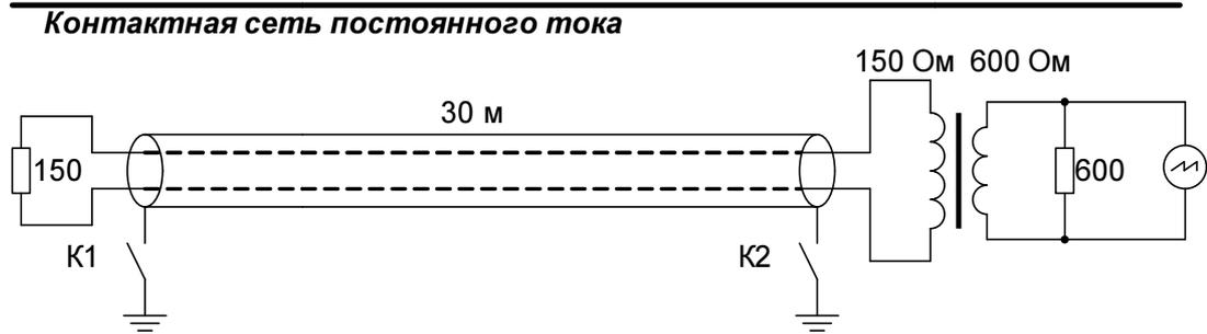
Рис. 3.22. Схема определения наведенных напряжений в симметричном экранированном кабеле в условиях влияния контактной сети ж.д.
