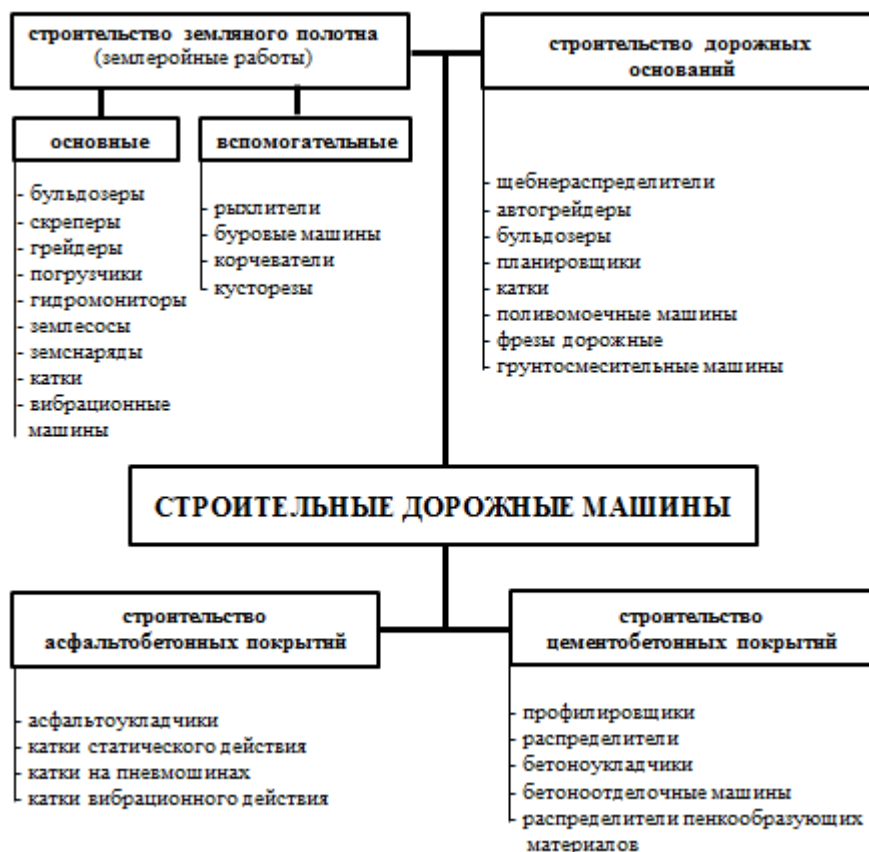
Рисунок 1.1 - Схема распределения дорожно-строительных машин по видам работ
