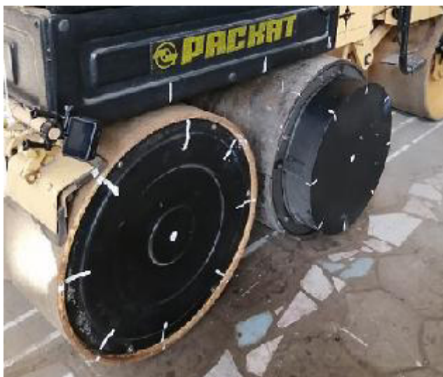
Рисунок 5.3 – Оборудование и приспособление для определения скорости катка
