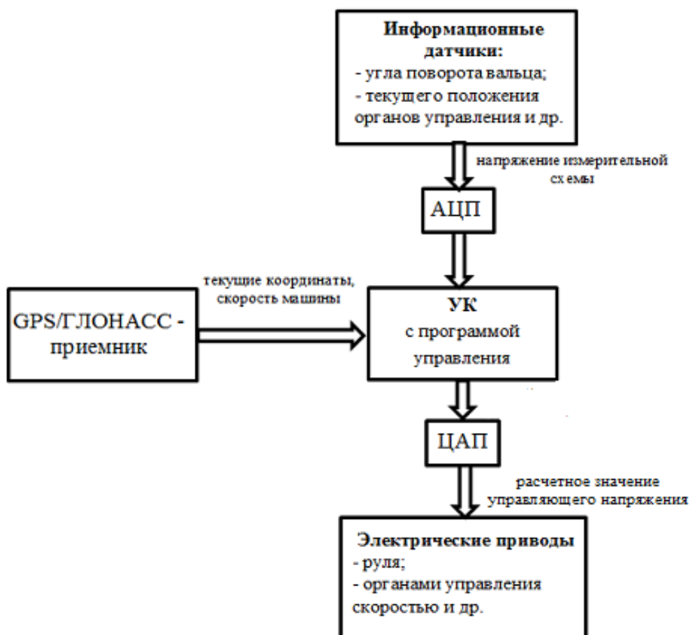
Рисунок 1.5 - Структурная схема системы автопилотирования [70]
