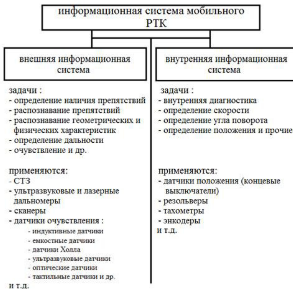
Рисунок 1.10 - Состав информационной системы мобильного РТК [90]
