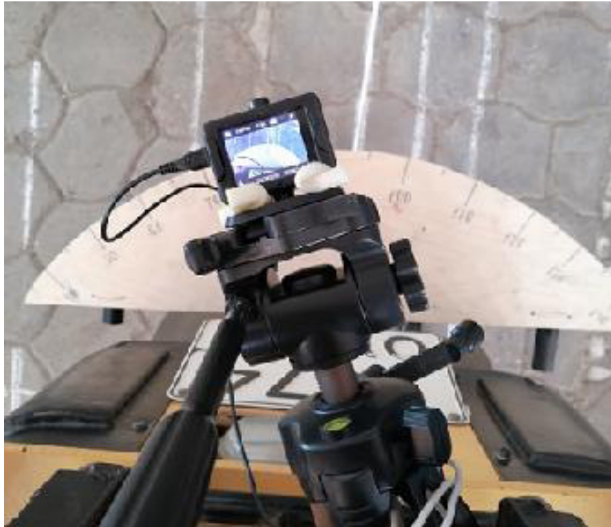
Рисунок 5.4 - Оборудование и приспособление для фиксации и расчета скорости поворота поворотного вальца машины
