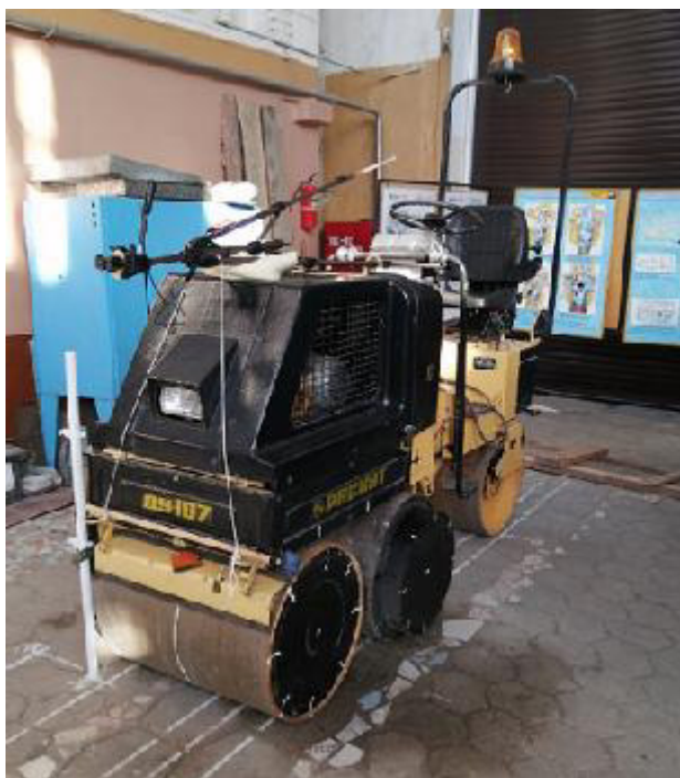
Рисунок 5.2 – Экспериментальные исследования дорожного катка ДУ – 107
