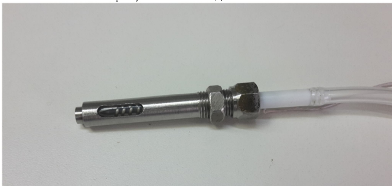
Рисунок 7 – Общий вид электродугового ЭТМД по чертежу 14.574.21.0104. МД 8000-000 ВО
