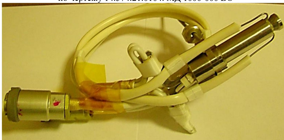
Рисунок 2 – Общий вид ЭТМД с трубчатым нагревательным элементом по чертежу 14.574.21.0104. МД 3000-000 ВО с длиной газоведа 29 мм
