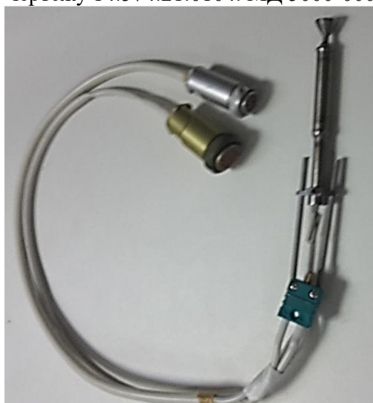
Рисунок 5 – Общий вид ЭТМД с совмещенной с испарителем схемой по чертежу 14.574.21.0104. МД 6000-000 ВО
